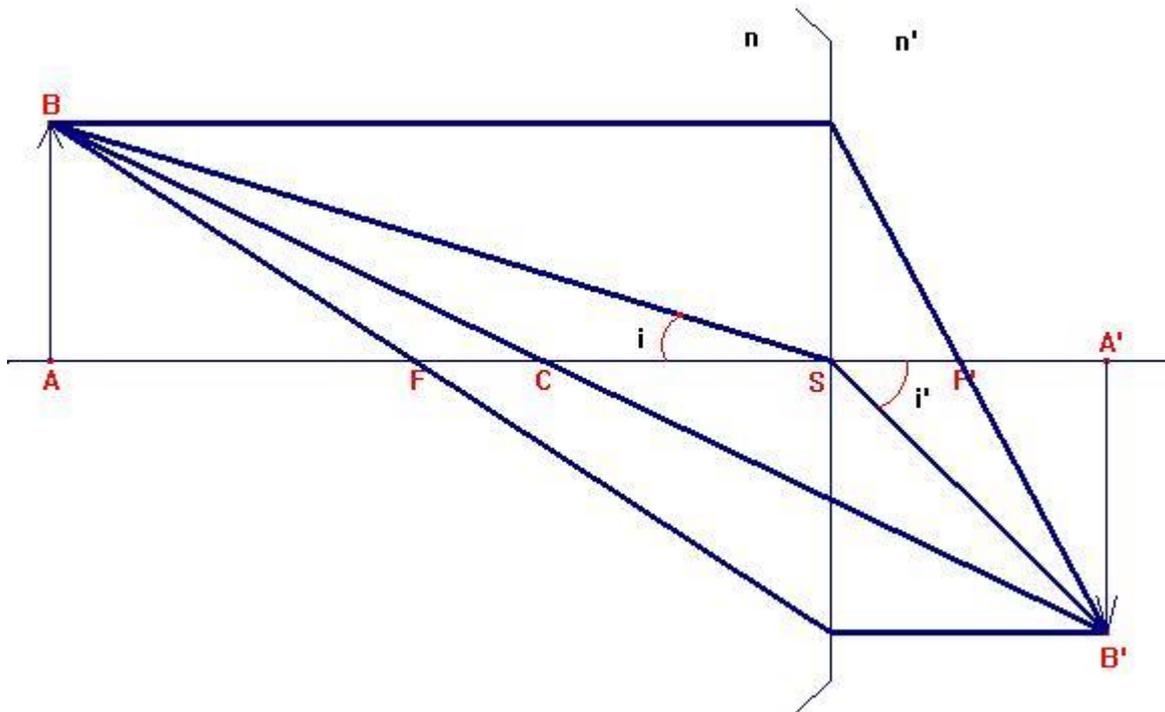
N.B. : Sur la figure, pour qu'elle soit lisible, on a dilaté les dimensions perpendiculairement à l'axe optique. Sur cette figure les angles que forment les rayons avec l'axe optique sont donc beaucoup plus grands qu'en réalité. On peut donc utiliser les approximations  $\tan(i) \approx i$  et  $\tan(i') \approx i'$  pour le raisonnement.
